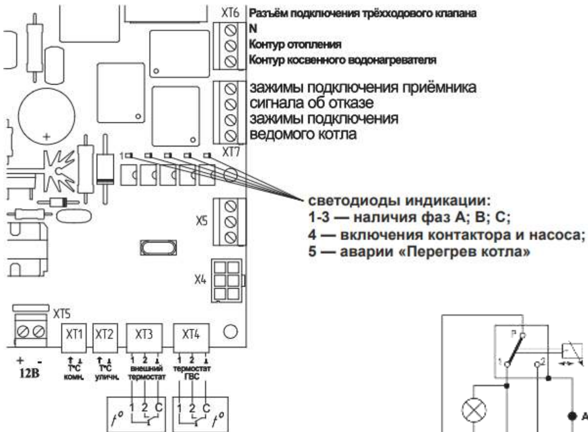
Рис. 1 Схема коммутационной платы котла STOUT.
